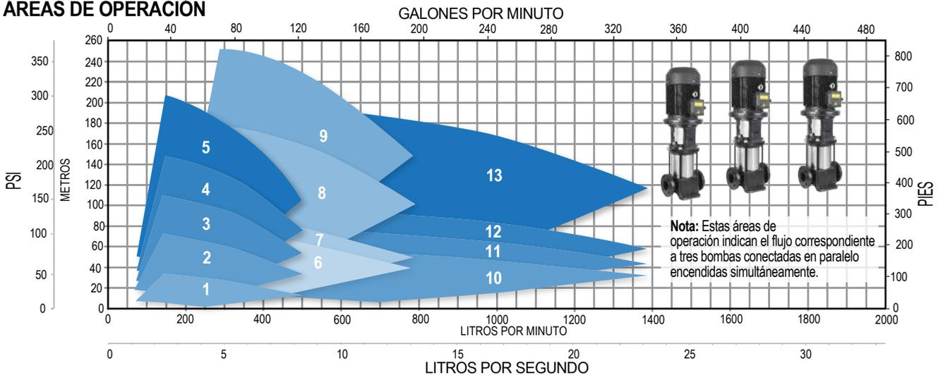
Nota: Estas áreas de operación indican el flujo correspondiente a tres bombas conectadas en paralelo encendidas simultáneamente.
